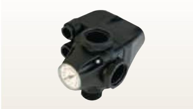
Pressostato per acqua monofase 1-5 bar, connessione a 3 vie, prolungato x 1" F x 1" F con anelli metallici rinforzati più manometro incorporato. Taratura di fabbrica 1,4-2,8 bar 16(10)A-250V IP44
