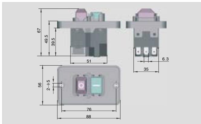
Interruttori con bobina di minima. Pulsante a fungo per arresto di emergenza IP54
